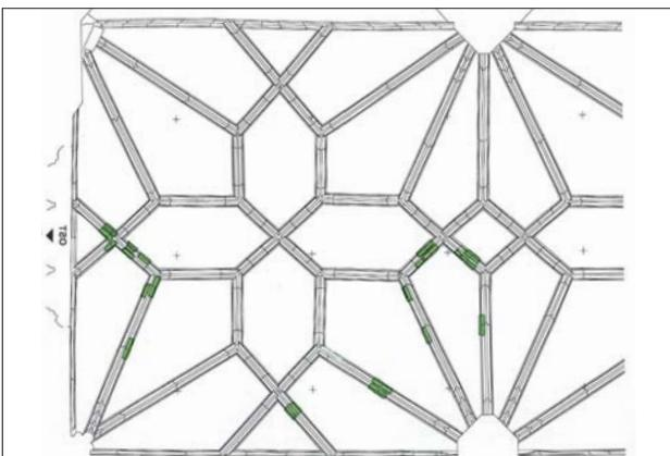
■ verrostete Dübel, freigelegt, entrostet, mit Oxatrol und Rost Primer Plus (Low) als Restschutz behandelt.
