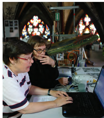
I. r. Cornelia Marinowitz (links) und Christine Bläuer (rechts) bei XRF-Messungen an einer Vergoldung. Die beiden Wissenschaftlerinnen bei der Diskussion und Auswertung der Messwerte.
