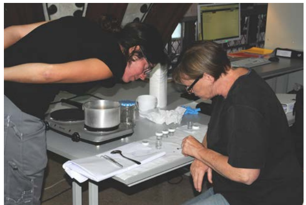
Voruntersuchung von Probenmaterial: gibt es einen Anstrich auf dem Stein?
