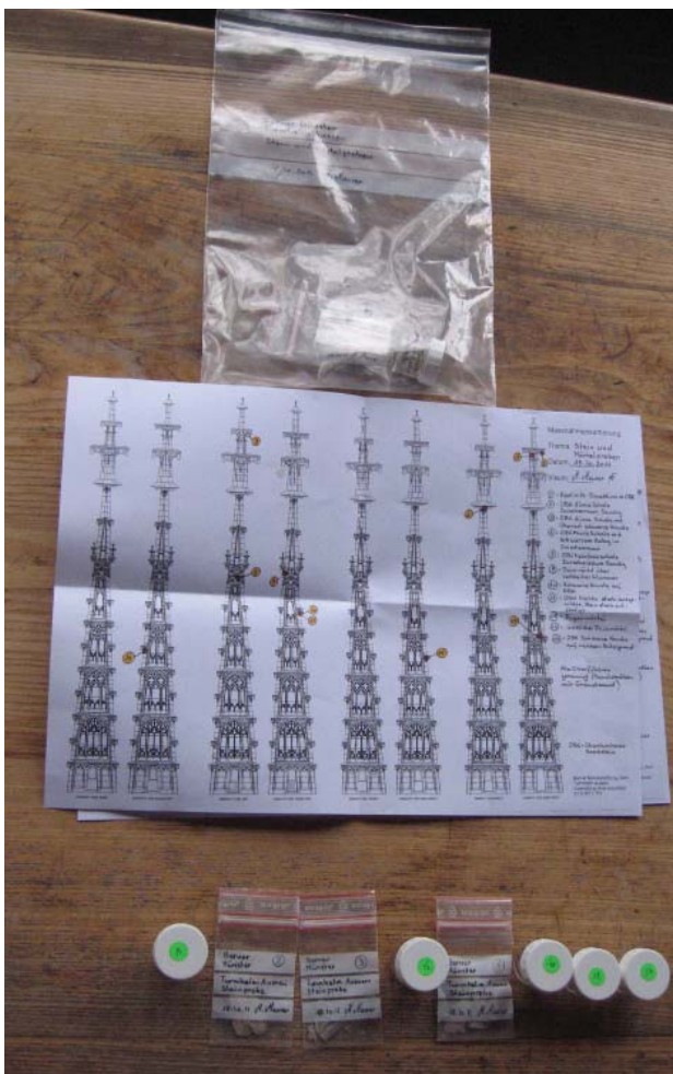
(1.) Probenentnahmen am Turmhelm. Die Proben wurden zur Laboranalyse an CSC Fribourg geschickt und könnten unter anderem Aufschluss über bislang undefinierte historische Behandlungsmittel bringen.
