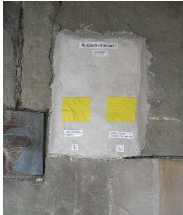
Auszugsversuche an Mörtelarmierungen: Verschiedene eingemörtelte Armierungen (Chromstahlröhren, Glasfasern) werden bis zum Ausreißen aus dem Mörtel respektive bis zum Zerreißen der Armierung auf Zug getestet.
