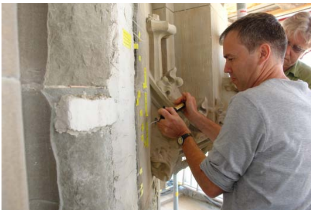
Auszugsversuche an Mörtelarmierungen: Verschiedene eingemörtelte Armierungen (Chromstahlröhren, Glasfasern) werden bis zum Ausreißen aus dem Mörtel respektive bis zum Zerreißen der Armierung auf Zug getestet.
