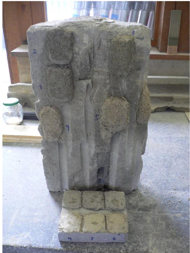
**(o.) Anfertigung von Kernmörtelproben für die Laboranalyse durch CSC Fribourg 2009/2010. Die Mörtel wurden möglichst realitätsnah an vertikal aufgestellten Prüfkörpern erstellt.**
