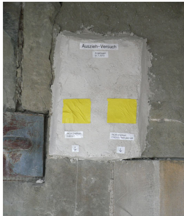
Auszugsversuche an Mörtelarmierungen: Verschiedene eingemörtelte Armierungen (Chromstahlstäbe, Glasfasern) werden bis zum Ausreißen aus dem Mörtel respektive bis zum Zerreißen der Armierung auf Zug getestet.
