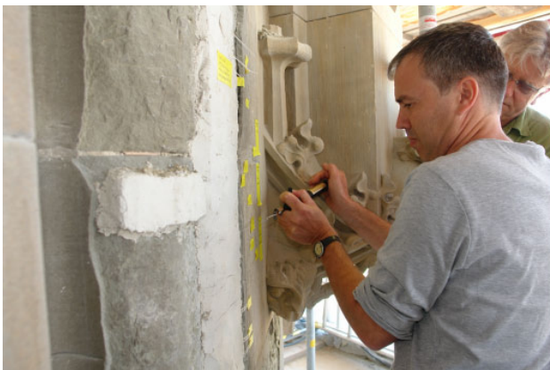
Auszugsversuche an Mörtelarmierungen: Verschiedene eingemörtelte Armierungen (Chromstahlstäbe, Glasfasern) werden bis zum Ausreißen aus dem Mörtel respektive bis zum Zerreißen der Armierung auf Zug getestet.
