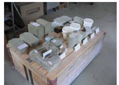
Zusammenstellung der Festigungsversuche aus den vergangenen zwei Jahren in der Münsterbauhütte
