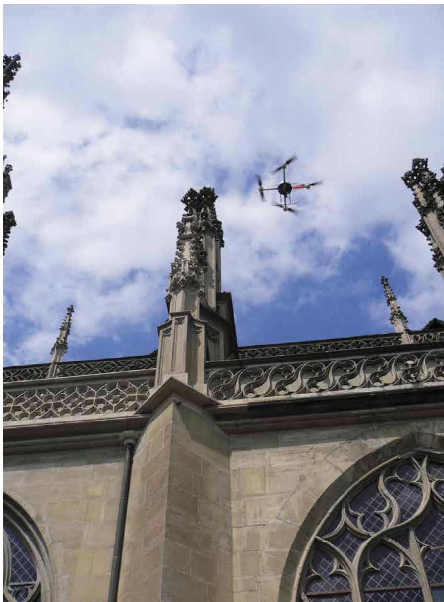
Versuch zur Anfertigung von Schlusszustandsfotos am Turm mit einer Mikrodrohne
