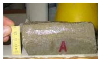
Parallel zu den Bewitterungsversuchen am Bau wurden unter gleichen Bedingungen in der Münsterbauhütte Probekörper für die Laboruntersuchungen hergestellt. Dabei wuchs Alfred Buri an der Fräse über sich hinaus - selbst im Mikrobereich und unter kritischer Beobachtung durch das Expert-Center übertraf er alle Erwartungen!
