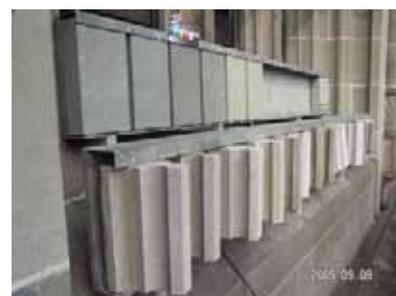
Oben: Prüfkörper mit verschiedenen Mörtelmischungen sowie Oberflächenbehandlungen und Fugenmuster werden auf allen vier Turmseiten in der Zwischengalerie der freien Witterung ausgesetzt. Die minimalen Grundlagen für eine allfällige wissenschaftliche Auswertung des ursprünglich rein empirisch gedachten Versuchsreihe wurden durch das Expert-Center in letzter Minute sichergestellt.
