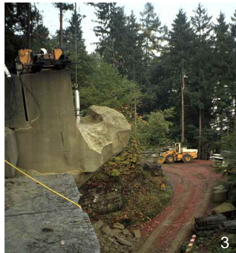
2 Schneiden mit der Schrämmaschine, Sicherung der Arbeitsgeräte mit dem Bagger
