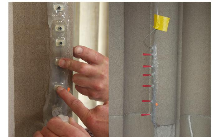
1. Versuchsreihe: Zwei zirka 15 x 20 cm grosse Sandsteinplatten wurden zusammengefügt und die Verpressmasse wurde über einen Metallpacker von unten nach oben mit einer Spritze eingepresst. Die Platten wurden nach dem Erhärten der Masse auseinandergenommen, um die Füllwirkung zu überprüfen.
