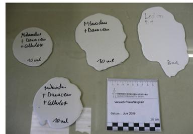
Auf einer Glasplatte wurde die Fließfähigkeit der unterschiedlichen Materialien überprüft.
