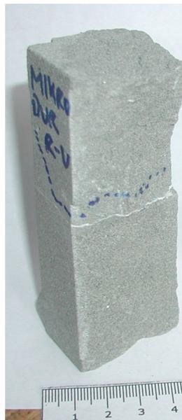
Versuchskörper mit verpressten Rissen wurden aufgesägt und die Eindringtiefe überprüft. Die Ergebnisse waren sehr unterschiedlich, der hier abgebildete Mikrozement verfüllt Risse bis zu 0,3 mm.
