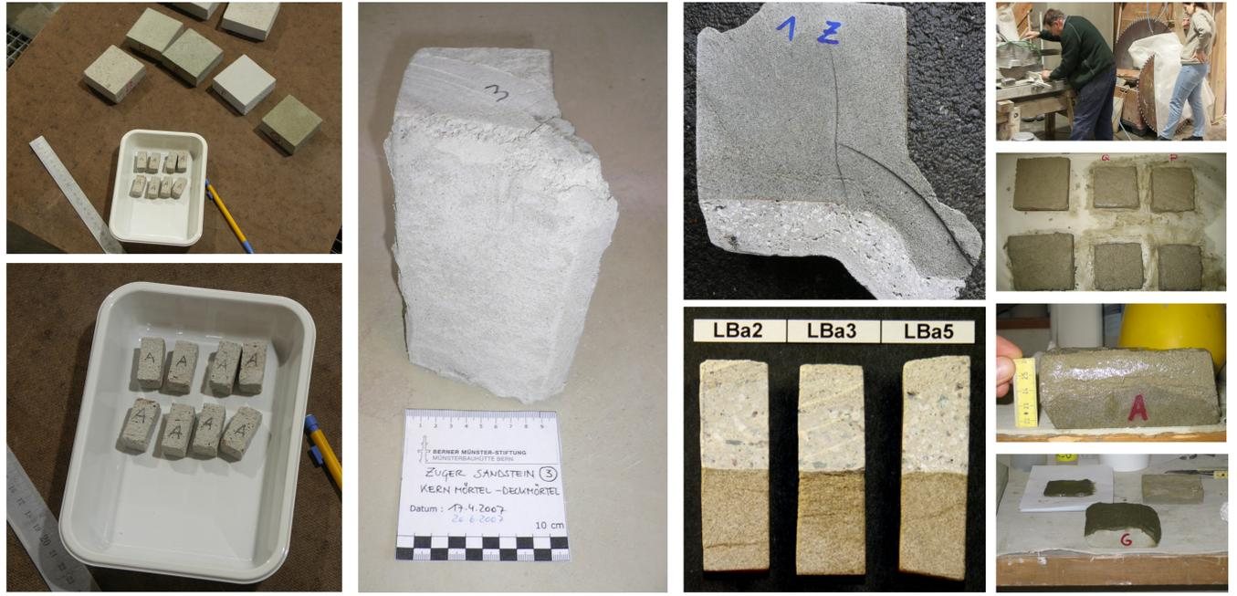
Parallel zu den Bewitterungsversuchen am Bau wurden unter gleichen Bedingungen in der Münsterbauhütte Probekörper für die Laboruntersuchungen hergestellt. Fotos mit Ausnahme oben rechts: Bénédicte Rousset, CSC Fribourg.
