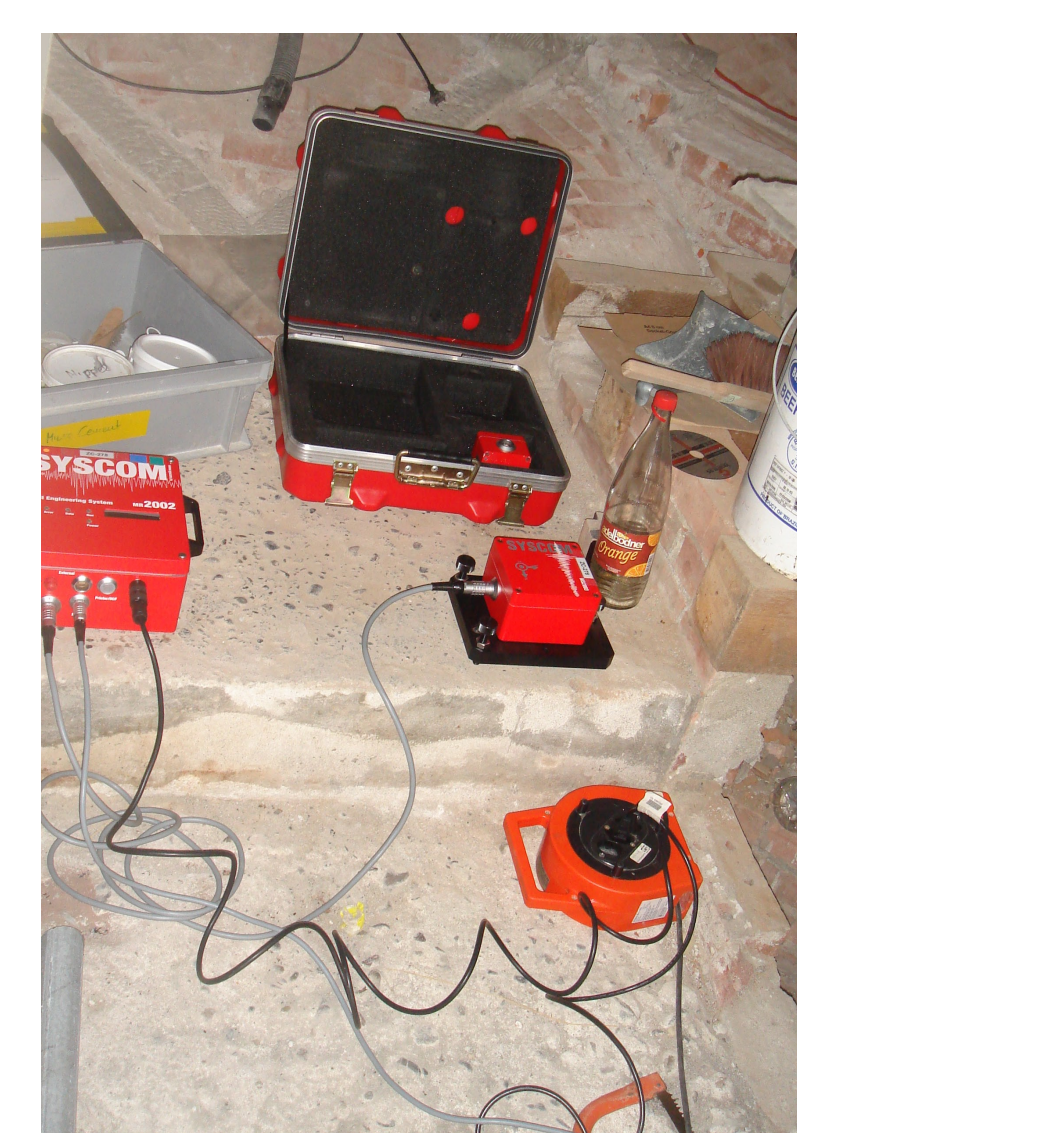
Oben: Schwingungsmessungen am Turm vom 21.08.2007 durch Ziegler Consultants, Zürich
