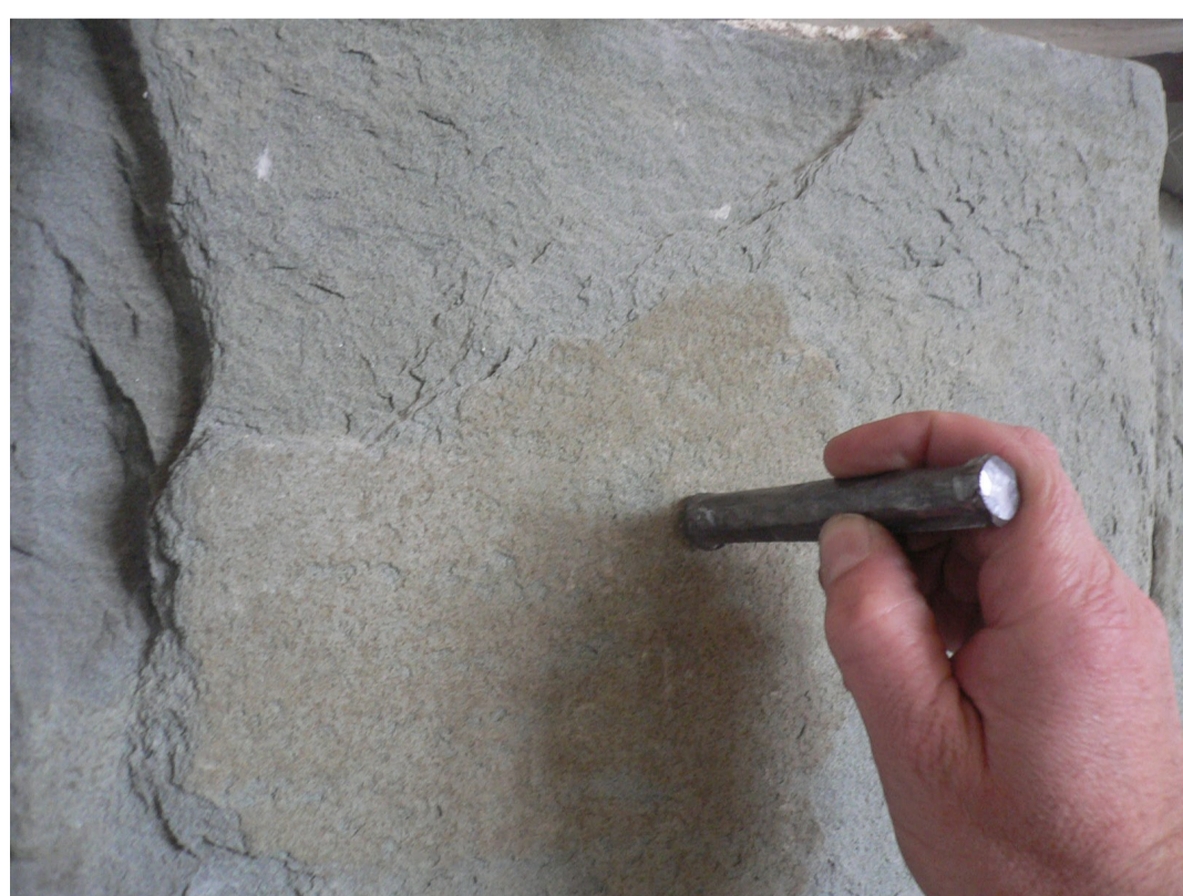
Am besten und zerstörungsfreisten hat sich ein Bleistößel zur akustischen Detektion von Schalen bewährt.
