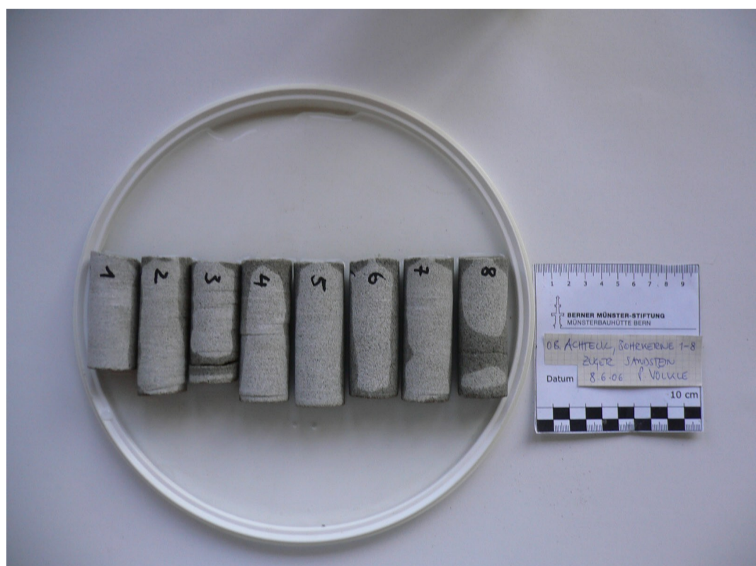
An Bohrkernen, welche in Wasser gelegt wurden, konnten die tiefliegenden Lockerzonen deutlich beobachtet werden
