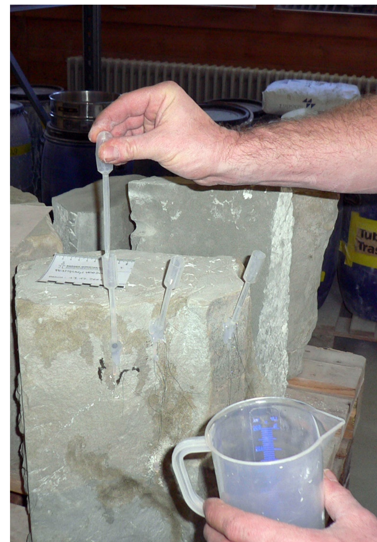
Versuche an ausgebauten Werkstücken in der Bauhütte unter Anleitung von Bruno Portmann, mattec+ Lenzburg. Verfahren und eingebrachte Materialien wurden später mehrere Male, auch in Absprache mit CSC Fribourg, modifiziert und auf die Berner Bedürfnisse angepasst.
