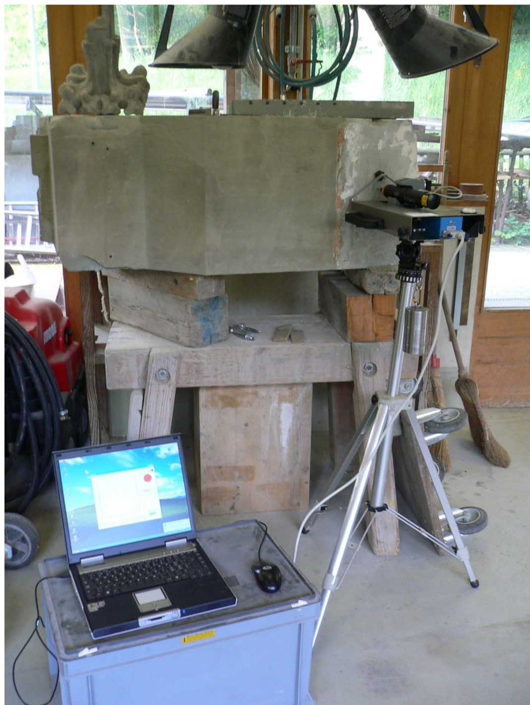
Versuche mit dem Bohrwiderrstandsmessgerät in der Bauhütte brachten leider nicht die erhofften Erfolge.
