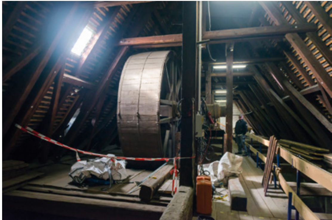
Unter dem Dach befindet sich ein Tretrad (Bild l.), das durch ein Loch (Bild u.) die Lasten hochzieht.
