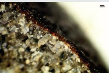
**Probe 69.6** (Flügel des Engels) Auf Sandstein liegt ein halbtransparentes Rot, es gibt eine sehr dünne Metallfolie und eine dünne grobkörnig pigmentierte Schicht (Lüser aus Azurit und rotem Lack). (Vorläufiges Untersuchungsergebnis).
