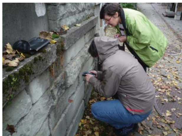
(o.) Versuche zur Überprüfung der Feuchtemessung mit dem HMP2000 am 3.11.2011 in der Münsterbauhütte.
