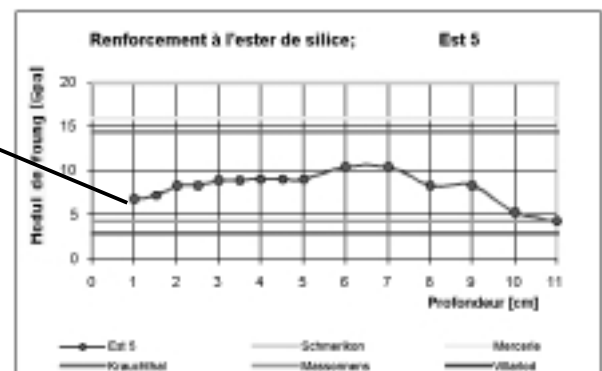
Produit 2, à 8 l/m 2 : bonne résistance jusqu'à 9 cm, renforcement probable à 8 - 9 cm ; situation satisfaisante.
